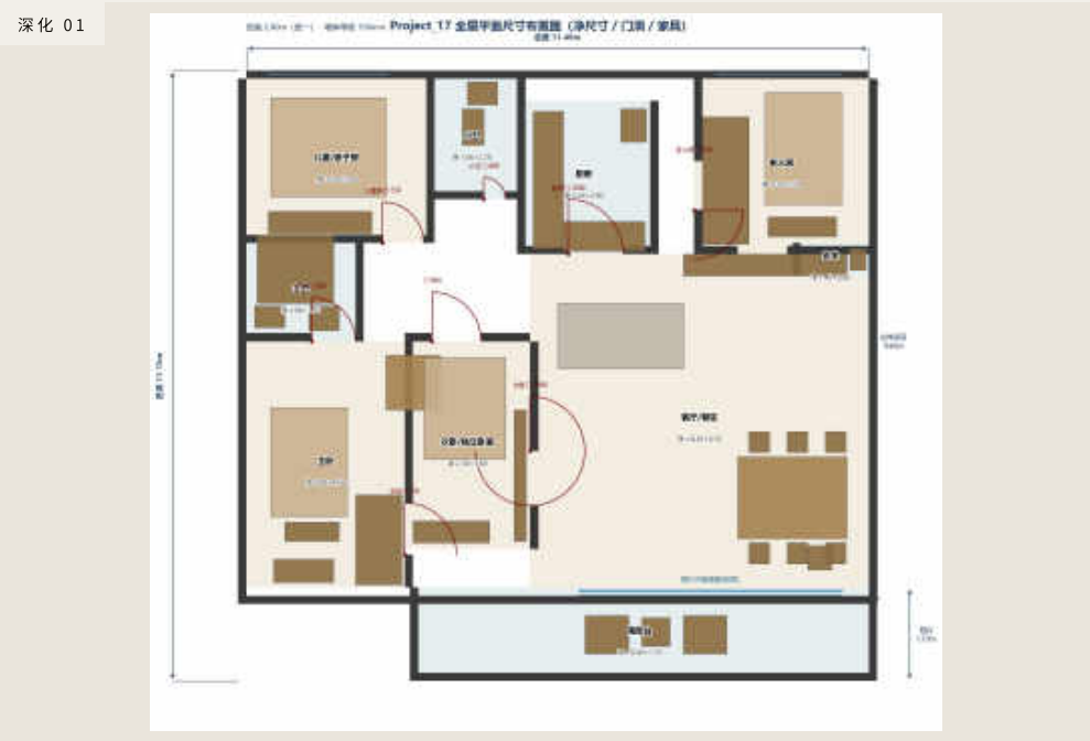
平面尺寸布置图 — 墙体定位、家具尺寸、通行宽度全部标注
