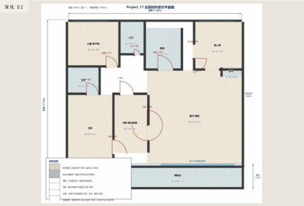
材料索引图 — 每个分区填材料编号，图例对应做法与规格
